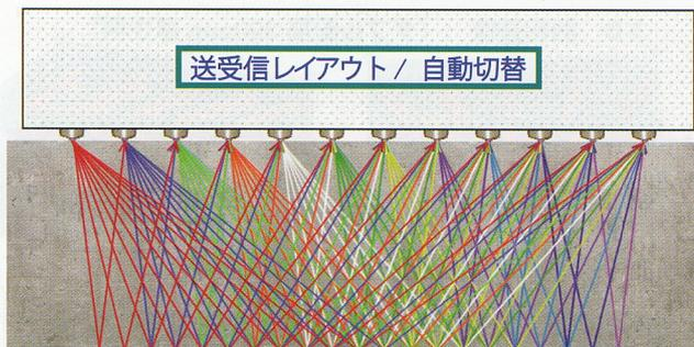
キャリブレーションも簡単で、特に対比試験片を用意する必要がありません。底面信号が受信できれば、12CHのセンサー位置が分かっていますので、複数の組み合わせの送受信センサー間距離と、それぞれの伝搬時間から厚さが求められ、さらには材質の音速が自動演算されます。このため、キャリブレーションの必要無しに測定作業が開始できます。
