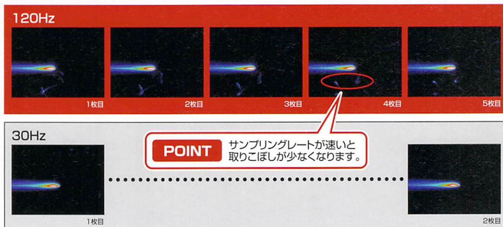
レーザー溶接モニタリング例(対象物:ステンレス、レーザー出力:250W、スキャン50mm)
